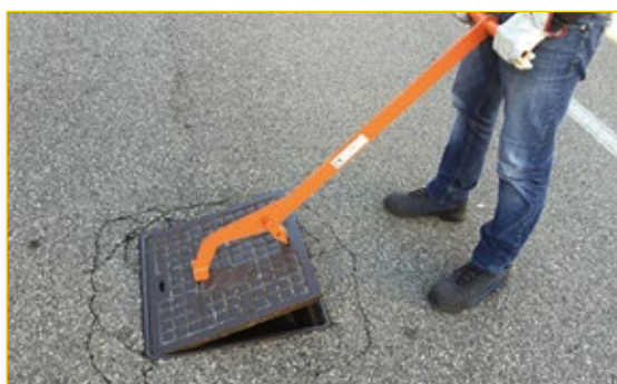
En la operación de levantamiento la longitud de la palanca limita el esfuerzo del operador.
