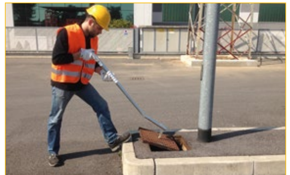
Las empuñaduras de plástico duro aseguran un agarre perfecto de la herramienta.
