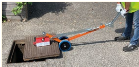
Uso 4: levantamiento magnético con imán permanente (PM400 o PM500) para tapas muy pesadas.
