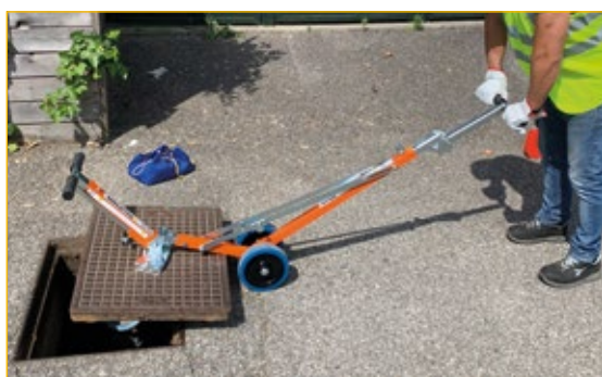
Uso 2: levantamiento con palanca plegable APS90 – APS80.
