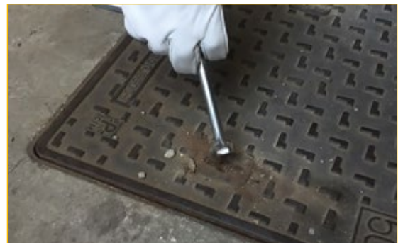
Configuración 3 Extremidad en "T" que hay que utilizar como aleta o chaveta de introducción en los ojales.
