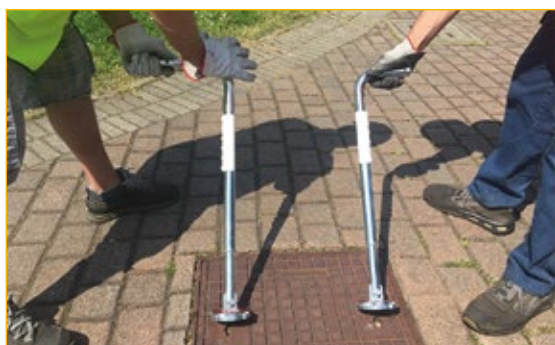
Útil para dividir el esfuerzo entre dos operadores con plena seguridad.
