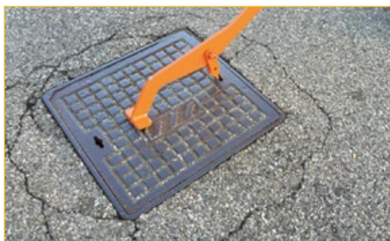
Introducción del diente en el ojal y rotación de 90°.
