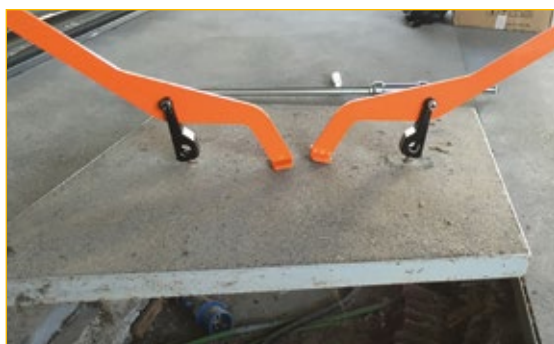
Uso de dos herramientas para tapas muy grandes.
