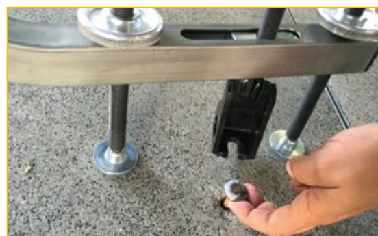
Tirante central con gancho giratorio y corredizo. En el detalle es visible el enganchamiento central hembra.
