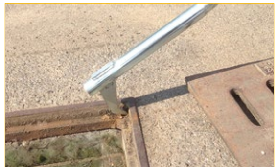
La uña puede utilizarse como un fuerte desincrustador/limpiador de los marcos.
