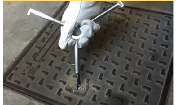
Configuración 1 Extremidad con punta helicoidal para romper y rasar.
