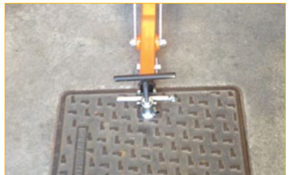
Fase 2: enganchamiento de la palanca en el borne. Uso
