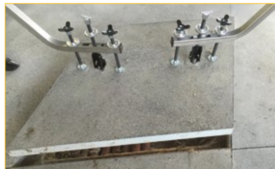
Pies de los punzones laterales articulados para garantizar un apoyo perfecto de toda superficie.
