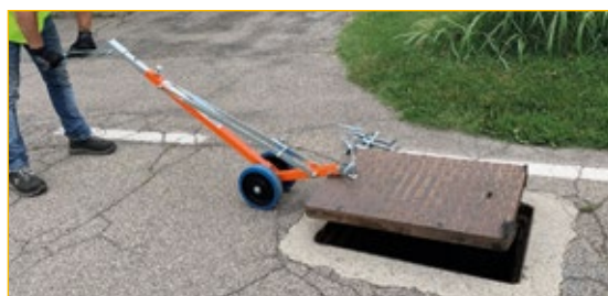
Uso 3: levantamiento mecánico con bornes de bloqueo.
