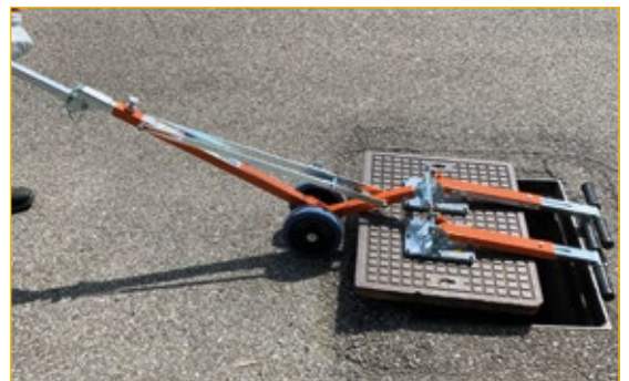
Uso 3: levantamiento con dos placas en paralelo y palanca sobre carro APS90.
